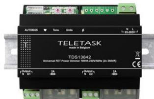
Le TDS13642 est un variateur de puissance sur AUTOBUS à deux canaux pour une variation à 230V/50Hz des lumières traditionnelles, LED et autres lumières graduables. Le variateur peut également commander des lampes et des LED qui sont branchées sur des transformateurs traditionnels et électroniques. Ainsi, le gradateur peut être configuré pour fonctionner en coupure de début (Leading) ou de fin (Trailing) de phase.
