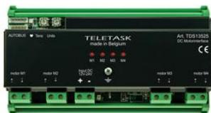
Interface moteur CC de TELETASK pour la commande de 4 moteurs CC. Cette interface AUTOBUS est conçue pour la commande de moteurs de 12 V CC à 24V CC, comme appliqués communément sur des volets, lamelles, stores à commande électrique. L'interface est raccordée au bus AUTOBUS.
