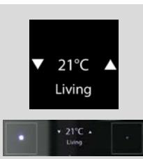
**Capteur sélectionné + zone:** ce champ indique la zone du capteur sélectionné et la valeur mesurée de cette zone.
