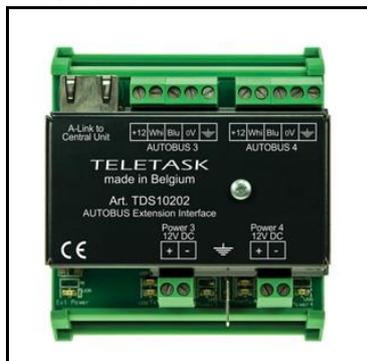
Interface d'extension pour utilisation avec la centrale MICROS+ pour augmenter le nombre de raccordements AUTOBUS de 2 unités (AUTOBUS 3 et 4).
